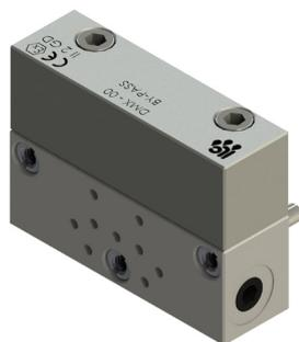
En ce qui concerne les dimensions, l'élément by-pass est identique au modèle doseur, mais ne contient pas le piston. Il a la fonction de créer une position de réserve s'il est nécessaire de modifier le nombre des sorties.
