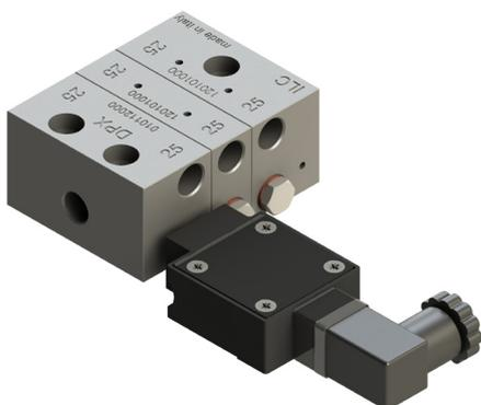
Ce contrôle est constitué par un interrupteur contenu dans un bloc. Le piston qui se déplace dans son logement de fonctionnement ouvre et ferme le contact de l'interrupteur.
