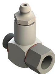
Les raccords **Banjo** sont installés à l'entrée ou à la sortie du distributeur progressif pour pouvoir utiliser une pompe manuelle ou pneumatique en cas de non fonctionnement de la pompe principale.
