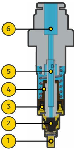
**A)** Vanne en condition de repos. **(1)** Ligne principale **(2)** Joint à chapeau **(3)** Zone de charge **(4)** Piston de dosage **(5)** Chambre de dosage **(6)** Ligne de sortie.
