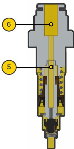
**D)** En actionnant à nouveau la pompe, l'huile présente dans la chambre de dosage **5** sera envoyée au point à lubrifier.
