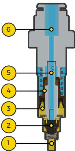
**B)** En actionnant la pompe, l'huile sous pression arrive au trou **1** et, au moyen du rétrécissement de la lèvre du joint **2** permet l'entrée du lubrifiant dans la zone **3**, en déplaçant par conséquent le piston **4**. Au premier actionnement, le doseur expulsera de l'air à la sortie **6** par la chambre de dosage **5**.
