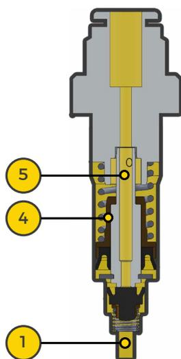
**E)** En enlevant la pression, le joint **1** et le piston **4** reviennent à la position initiale et permettent à l'huile de remplir complètement la chambre de dosage **5** afin d'être prêts pour un nouveau cycle.
