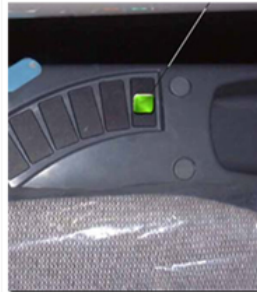
Bouton poussoir optionnel avec alarme lumineuse et sonore
